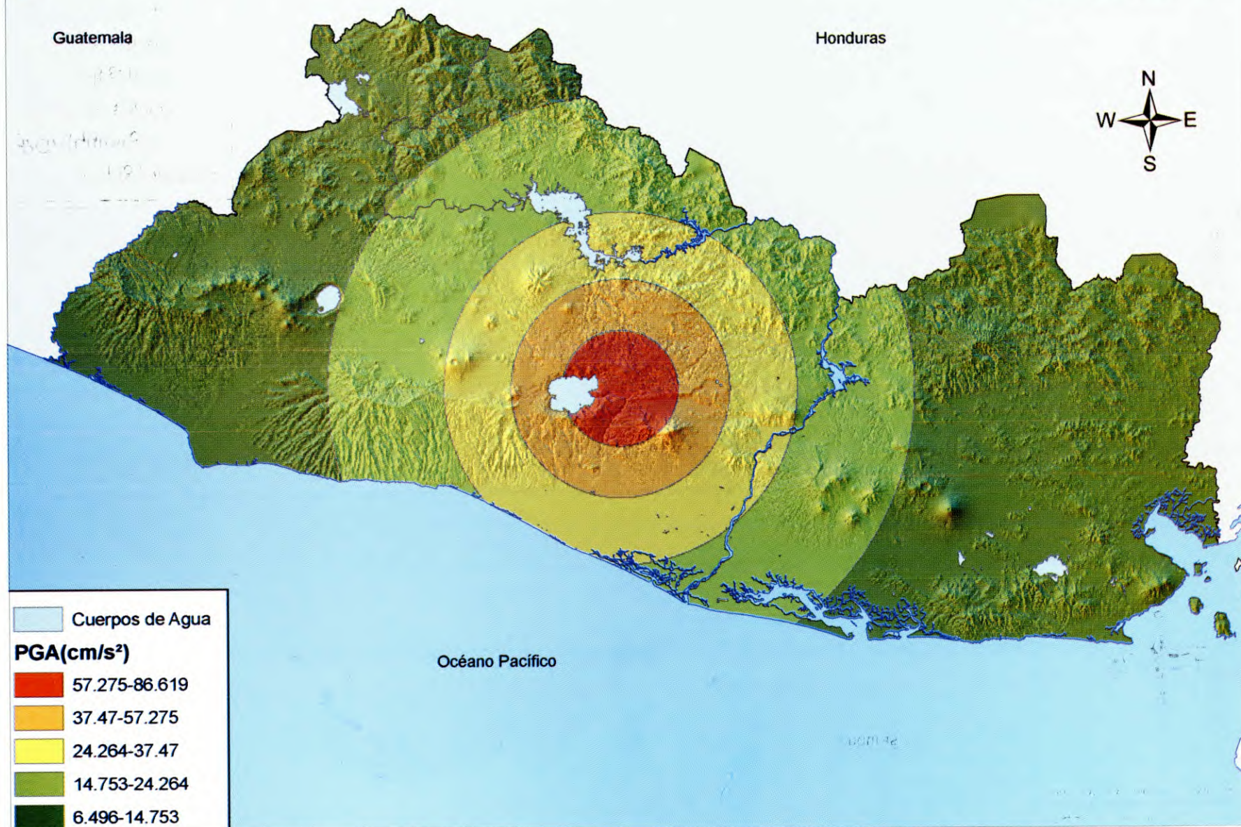
Figura 3.11. Distribución espacial de aceleración máxima horizontal para el terremoto del 13 de febrero de 2001. Simulación desarrollada con la ecuación 3.2 ajustada, para fuente puntual y condiciones de roca en terreno plano.
